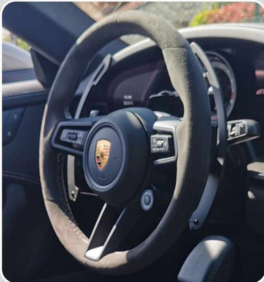
Accélérateur à palette fixé derrière le volant permettant à l'utilisateur d'accélérer. A ce dispositif nous ajoutons très souvent un frein à main au volant pour freiner.
